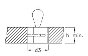
d1 = 16 d2 = 25 d3 = 25 d4 = M6 e = 3 For spring plunger = 10 H min = 18 I = 17.9
